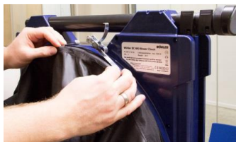
图 11: 将夹紧环推入主机风口的 外边缘
