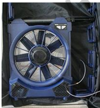
图 21: 已装好毛细导压管和电源电缆的主机
