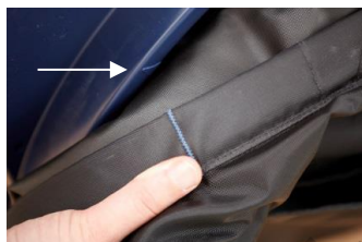
图9：箭头所指处为主机风口 外边缘上的对准标记
