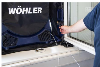
图 20: 毛细导压管穿过蒙布延伸至户外
