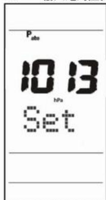
图 12: 默认设置的绝对压力值
