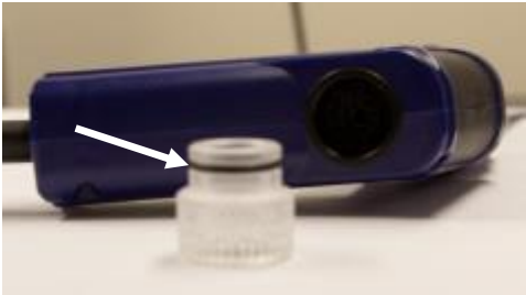
图. 36: 可拆卸式探针(选件)手柄后端堵头上的密封圈
