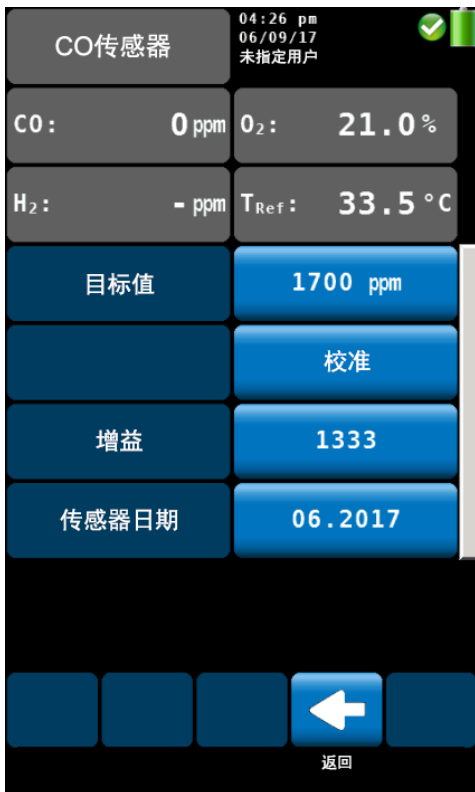
图. 49: 在校准菜单中输入校准值 (仅 CO 传感器)
