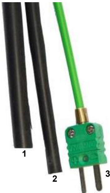
图. 16: 烟气探针的末端接头 烟气管路 (1)， 抽力管路 (2)， 烟温插头 (3)
