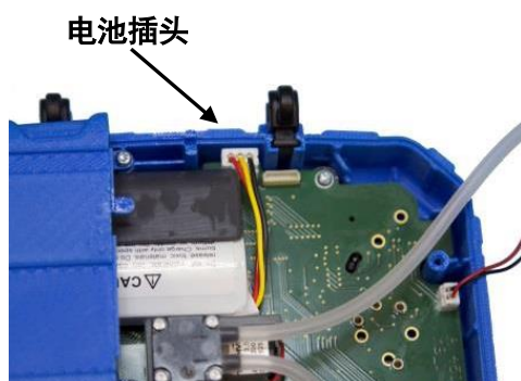
图. 50: 黑色适配器中的电池，传感器已拆除，O 2 传感器插头和导气软管仍然处于连接状态
