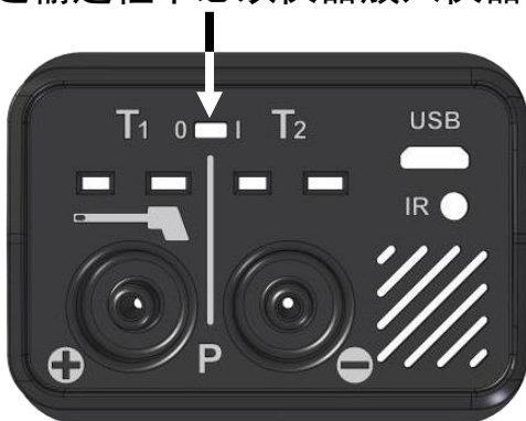
图. 1: 仪器底部的运输锁
