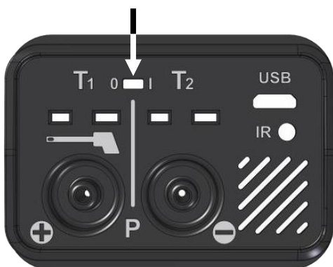
图. 12: 将电池锁拨向右侧可激活电池，将电池锁拨向左侧即可切断全部电源
